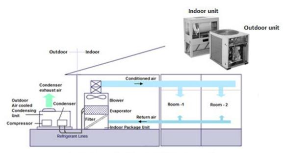
DUCTED PACKAGE HEAT PUMP UNIT (COOLING CYCLE)
